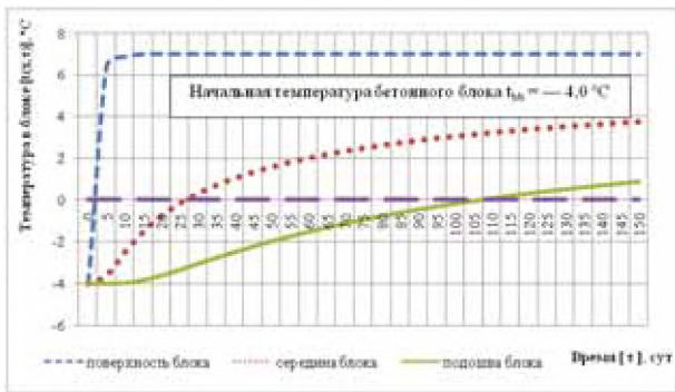
Рис. 6. Изменение температуры в бетонном блоке толщиной h = 3,75 м в течение 150 суток в морской воде с постоянной положительной температурой t_{w*} = +7,0 °C.
