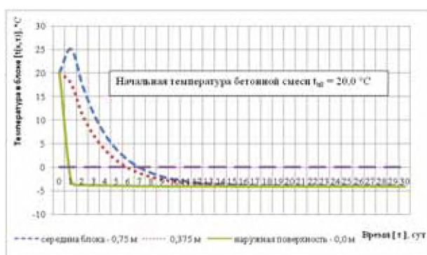
Рис. 5. Изменение температуры в бетонном блоке толщиной h = 1,5 м с химической добавкой НКМ (нитрат кальция с мочевиной в количестве 6%, цемент М 500), твердеющем в течение 30 суток в морской воде с постоянной отрицательной температурой t_{w-} = -4,0 °C (вариант № 3)
