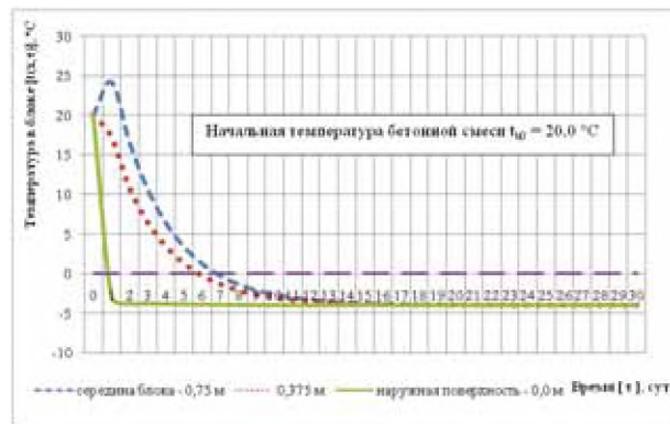
Рис. 4. Изменение температуры в бетонном блоке толщиной h = 1,5 м без химических добавок с экзотермией (цемент М 500), твердеющем в течение 30 суток в морской воде с постоянной отрицательной температурой t_{w-} = -4,0 °C (вариант № 2)
